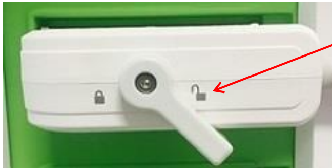
図29：ロック解除したトランスデューサコネクタロックつまみ
