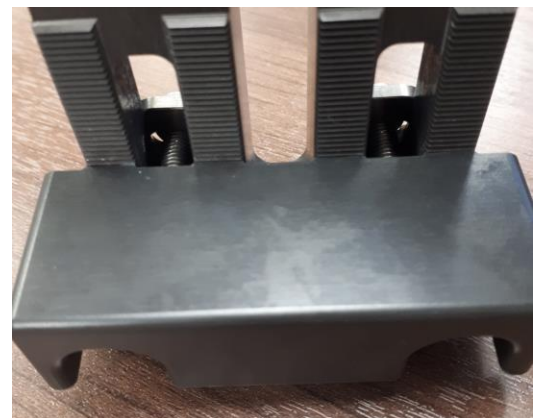
図38：中央に配置されたテンプレートグリッドホルダ
